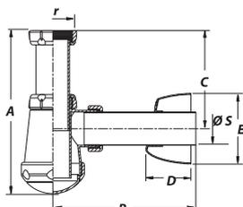
Бутылочный сифон регулируемый, с удлинительным патрубком и отражателем.
