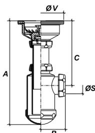
Бутылочный сифон, регулируемый, с сетчатым клапаном для мойки.
