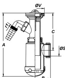
Бутылочный сифон, регулируемый, с выпуском для мойки. С отводом для подключения бытовой техники.
