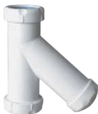
Вертикальный сифон из белого ПП, Ø32 мм или Ø40 мм, выход с конической прокладкой для быстрого монтажа, боковая пробка с резьбой.
