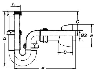
Сифон трубный регулируемый с патрубком и отражателем.
