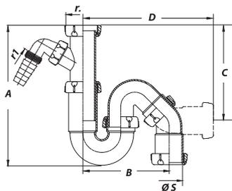
Сифон трубный регулируемый с отводом для бытовой техники.
