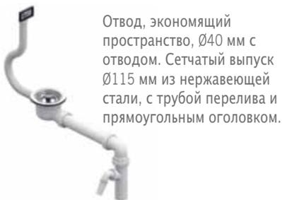
Отвод, экономящий пространство, Ø40 мм с отводом. Сетчатый выпуск Ø115 мм из нержавеющей стали, с трубой перелива и прямоугольным оголовком.
