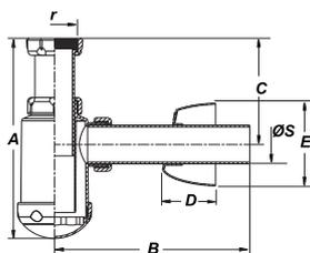
Бутылочный сифон, регулируемый, удлинительным патрубком и отражателем
