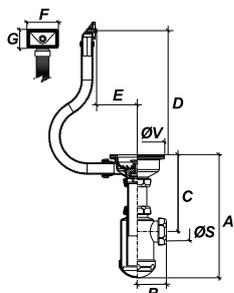
Бутылочный сифон, регулируемый, с сетчатым клапаном для мойки и переливом с прямоугольным оголовком.
