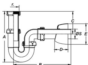
Сифон трубный регулируемый с патрубком и отражателем.
