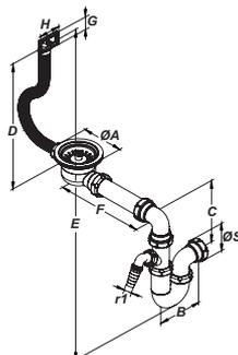
Сифон трубный, смещенный. С отводом для бытовой техники. С выпуском и переливом, для мойки.
