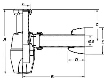
Бутылочный сифон Juntafix, регулируемый, горизонтальный выход, с патрубком и отражателем.
