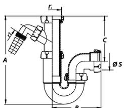
Сифон трубный регулируемый с отводом для бытовой техники.
