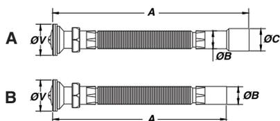
Выпуск Ø70 мм с гибким гофрированным отводом.
