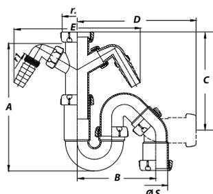
Сифон трубный регулируемый с двойным отводом для бытовой техники. electrodoméstico.
