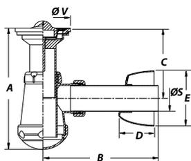
Бутылочный сифон регулируемый для мойки, с выпуском, удлинительным патрубком и отражателем.
