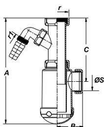
Бутылочный сифон, регулируемый, с отводом для электробытовой техники
