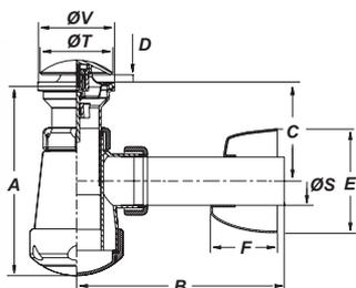
Бутылочный сифон регулируемый, с выпуском Click-Clack, удлинительным патрубком и отражателем.
