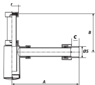
Бутылочный сифон регулируемый, горизонтальный выход, с патрубком и отражателем.
