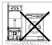
**APARATOS SANITARIOS** – El triturador está preparado para la conexión de un inodoro y 3 aparatos sanitarios (lavabo, bidet o ducha), no permite la conexión de electrodomésticos como lavadoras o lavavajillas equipados con equipo de bombeo que puede interferir el correcto funcionamiento del triturador.
