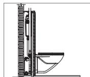
**DESCARGA** – El tramo de descarga siempre debe conectarse a la red de evacuación, no debe evacuar nunca en desagües abiertos, sumideros, etc.
