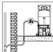
**PROTECCIÓN CONTRA HELADAS** – En zonas con riesgo de heladas por bajas temperaturas, todos los tramos de tubería que tengan riesgo de congelarse deben protegerse con aislantes térmicos.
