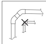
**TUBERÍA** – Utilizar tubería de PVC Ø32 mm a encolar para la impulsión para la descarga. Evitar tramos curvos (sifones) que puedan retener ciertos sólidos y producir obstrucciones. También se pueden emplear otras tuberías (28-22mm) con adaptador de junta y abrazadera metálica.
