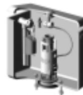
Trampilla de regulación del nivel de agua residual en el fondo de la cisterna. Posición arriba: máximo de agua. Posición abajo: mínimo de agua.
