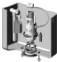
**4** Cortar el número de anillos definido en la instrucción 2, introducir el arillo en la posición indicada y volver a montar el mecanismo en el interior de la cisterna.
