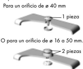
O para un orificio de  $\varnothing$  16 a 50 mm.
