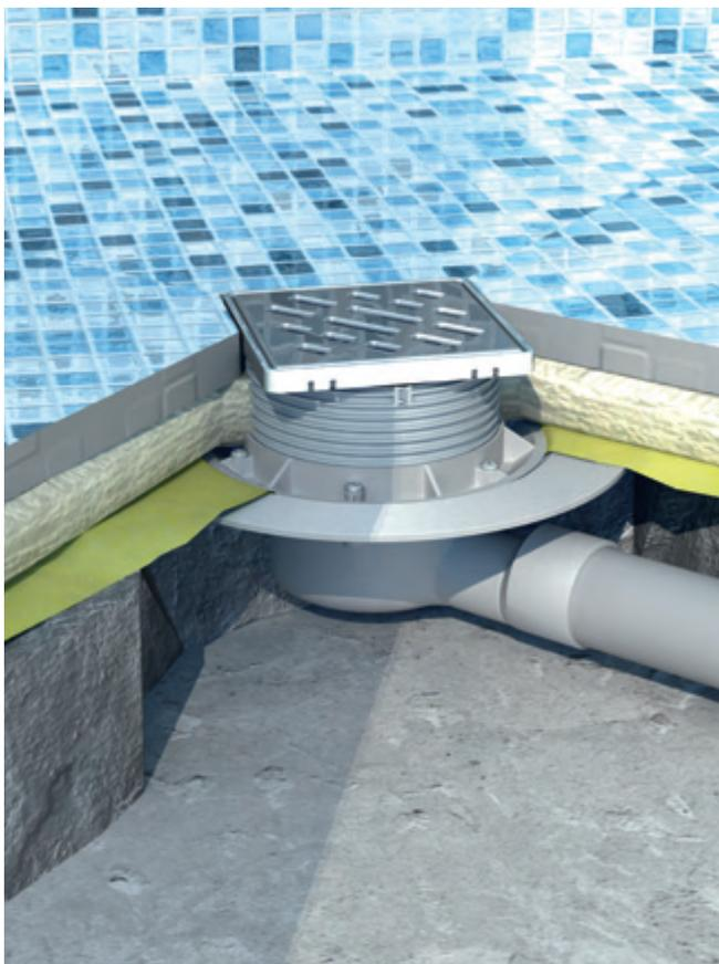
Las rejillas y cercos, realizados en acero inoxidable AISI 304, junto con los extensibles entre 20 y 113,5 mm de altura, logran un perfecto acabado para cualquier tipo de instalación. Disponibles en dos salidas, vertical y horizontal, cumplen con los requisitos de la norma EN 1253-2.
