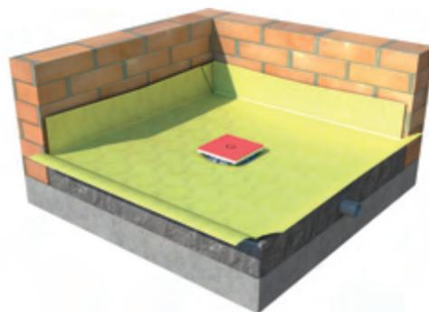
**07** Según el espesor requerido, corte la alargadera a la altura deseada y fije la junta tórica sobre la parte inferior de la misma. Instale firmemente la alargadera sobre el prensatelas (ya instalado y atornillado sobre el cuerpo del sumidero).
