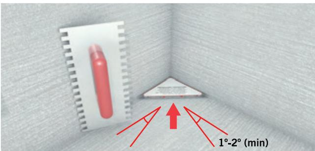
**13** Rellene el suelo con una pendiente del 1-2% hacia la canaleta. Alicata las paredes y el suelo.
