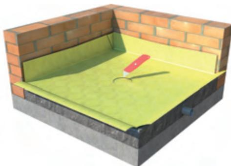
**04** Instale el elemento impermeabilizante (recomendamos el uso de lámina geotextil o de PVC) sobre la base cementada, recomendamos que dicha tela se extienda sobre la pared en vertical un mínimo de 10-15 cm, y especialmente en las esquinas, se superponga realizando pliegues en lugar de cortes sobre la misma.
