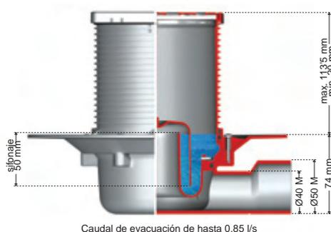
Los nuevos sistemas de prensatelas mecánicos facilitan la compatibilidad con los distintos tipos de telas de impermeabilización tanto de PVC como geotextiles (hasta 1 mm de espesor).
