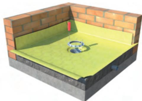
**05** Fije el elemento mecánico de sujeción (presatelas) mediante los 6 tornillos suministrados. Para facilitar el montaje alinee los agujeros de los tornillos del presatelas con las marcas triangulares del cuerpo de la caldereta.
