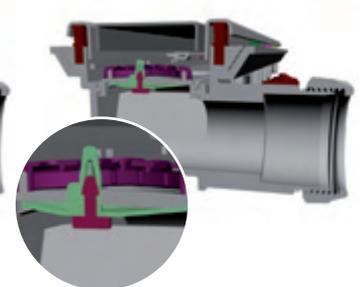
Las canaletas con válvula de aireación, están equipadas con una junta interior de silicona que se abre solamente en caso de succión, permitiendo la entrada de aire en la bajante y garantizando la conservación del sello hidráulico.
