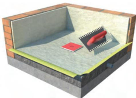
**08** Aplique cemento cola sobre la tela impermeable con el espesor deseado.
