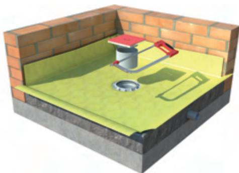
**06** El sumidero viene equipado con una alargadera que permite adaptarse a espesores de lámina impermeable desde 10 hasta 90 mm. Proteja para la fase de alicatado el cuello con la tapa de protección de obra suministrada.
