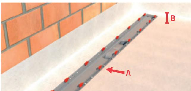
**10** Elija el pin A y su posición según el espesor de azulejo B y el cemento cola empleado (puede no ser necesario el uso de pines).
