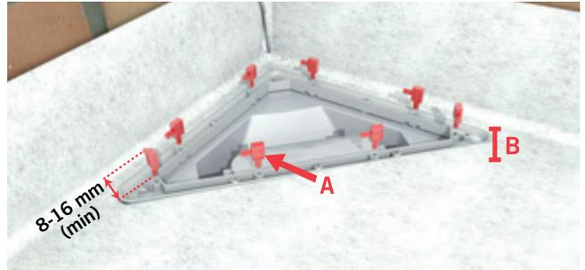
**10** Elija el pin A y su posición según el espesor de azulejo B y el cemento cola empleado (puede no ser necesario el empleo de pines).
