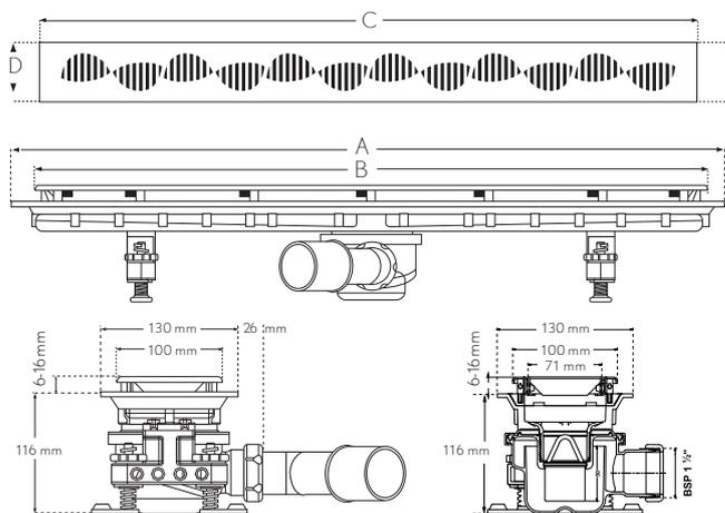
Con la gama Linum 70 formada por un cuerpo de canaleta con válvula de desagüe sifónica registrable, puede conseguir un caudal de evacuación de hasta 0,8 l/s (conforme a la norma EN 274). Adicionalmente dispone de una rotación de 360° que permite orientar la salida de la canaleta hasta la posición deseada.
