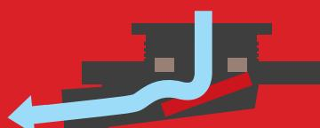
A água do duche exerce pressão sobre a parte móvel da válvula magnética que se abre permitindo a evacuação. Quanto maior é o fluxo de água, maior é a pressão.
