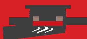
A força magnética assegura o fecho da válvula que combinado con a vedação hidráulica de 1cm garante a ausência de odores. É 100% hermético.
