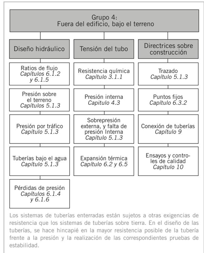
Ilustración 5.5 Fuera de los edificios, sistemas bajo el terreno
