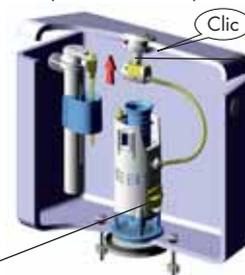
Trampilla de regulación del nivel de agua residual en el fondo de la cisterna. Posición arriba: máximo de agua. Posición abajo: mínimo de agua.
